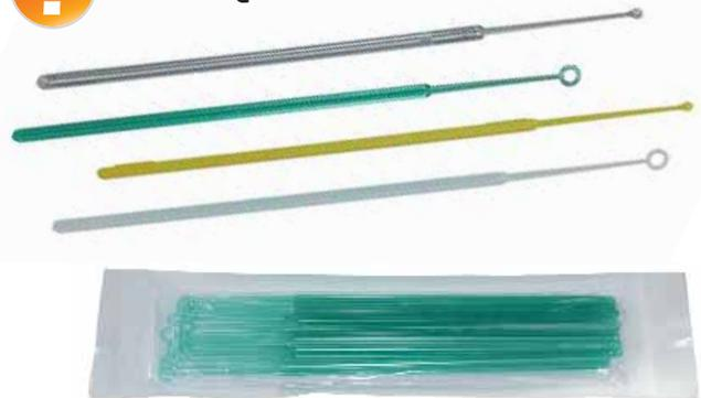
Gleichmäßige Benetzung und komplette Übertragung der Flüssigkeit. Die Impfösen sind in starrer Ausführung aus PS oder flexibler Ausführung aus HIPS verfügbar. Glatte Ränder sorgen für schonende Agar-Behandlung.
