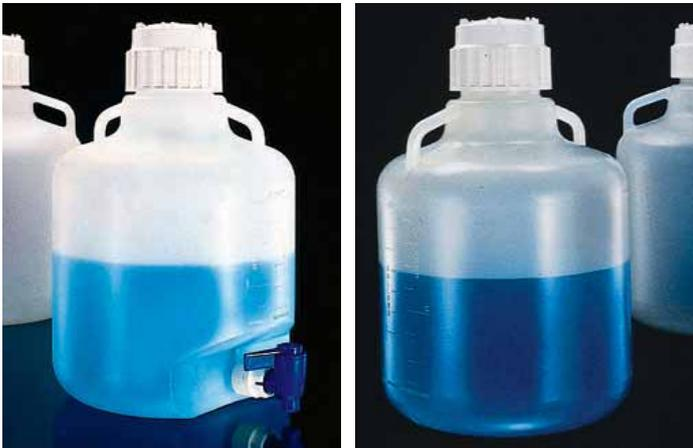
Mit Schraubverschluss Ø 83 mm. Mit Schulterhenkeln. Autoklavierbar. Graduiert. Für Nährmedien, destilliertes Wasser oder andere Lösungen. Auslaufsicher. Nicht mit aggressiven Substanzen verwenden. Öffnung auch für Stopfen mit 36 mm Höhe und einem Ø oben/unten von 75/62 mm geeignet. Zum Autoklavieren Verschluss entfernen oder entsprechend belüftbaren Verschluss benutzen.
