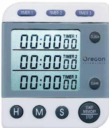
Drei getrennte Timer in einem Gerät. Countdown/-up. Alarm, wenn "0" erreicht ist. 12/24 Stunden umschaltbar. Schalter für laut/leise Alarm.
