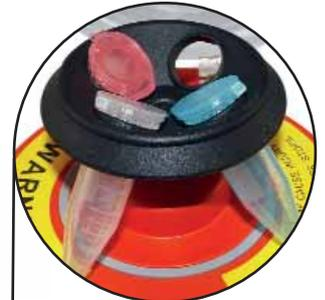
Kompakte und preiswerte Mini-Zentrifugen mit zwei unterschiedlichen Rotoren. Geschwindigkeit einstellbar auf 4000 min<sup>-1</sup> oder 6000 min<sup>-1</sup>. Leistungsstarker Motor für schnellen Anlauf. Schnellstopp bei Öffnung des Deckels.
