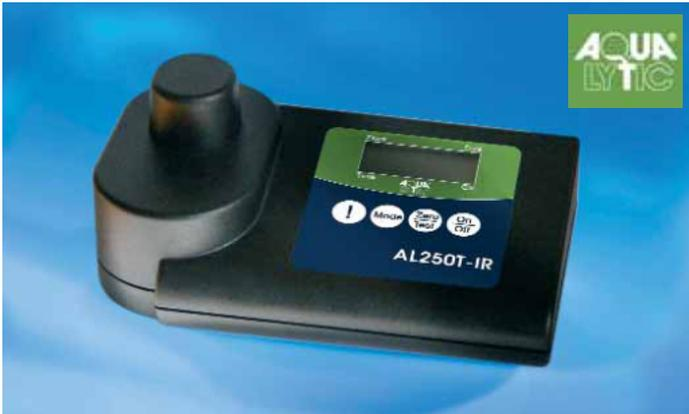
Das kompakte AQUALYTIC® Infrarot-Trübungsmessgerät AL250T-IR für die schnelle und exakte Vor-Ort-Analyse. Breiter Messbereich von 0,01 bis 1100 TE/F = NTU = FNU. Messungen mittels Infrarot für farbige oder farblose Flüssigkeiten.
