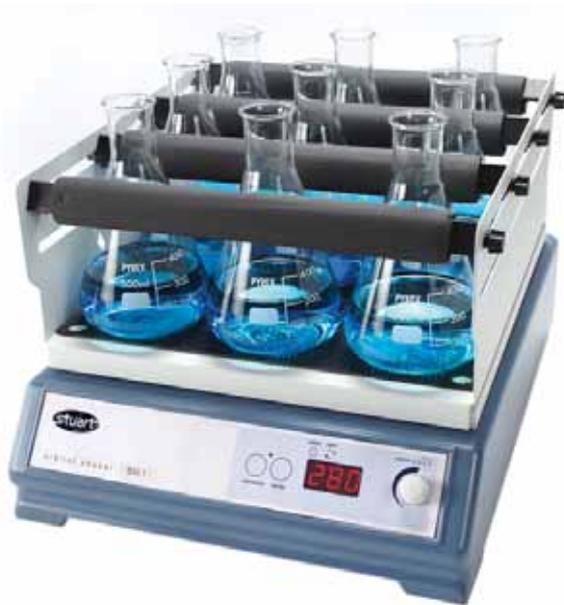
Dieser Labor-Plattformschüttler mit leistungsfähigem und dennoch ruhigem Rüttelmechanismus ist für den problemlosen Dauereinsatz konzipiert worden. Die Aufsätze haben vier gummi gepolsterte, horizontale Sicherheitsstangen, welche leicht horizontal und vertikal eingestellt werden können, z. B. für die Aufnahme von 12 x 250 ml oder 8 x 500 ml oder 6 x 1000 ml oder 2 x 2000 ml Erlenmeyerkolben. Mit BioCote-Beschichtung: spezieller, auf Silber basierender antimikrobieller Schutz.
