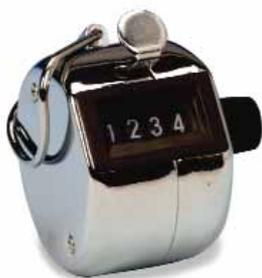
Zum Zählen von Blutzellen, Bakterienkolonien, Flüssigkeitstropfen oder generell im Fall eines interaktiven Prozesses. Zählt bis 9999. Reset-Knopf. Linse für gute Lesbarkeit. Ring zum sicheren Halten. Robust. Metallgehäuse mit Chrom- Oberfläche. Abmessungen: Ø 46 mm, Breite 41 mm.
