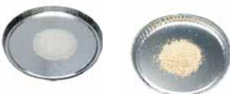
Hochwertiges Reinstaluminium auch zur Feuchtebestimmung sehr gut geeignet.
