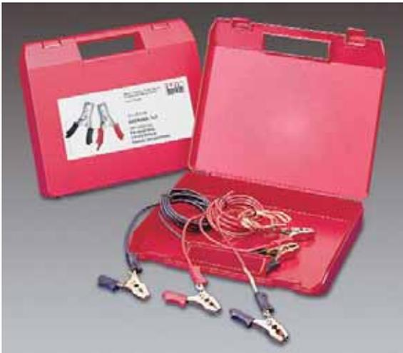
Beim Abfüllen brennbarer/explosiver Flüssigkeiten müssen Pumpe, Abfüll- und Zufüllgebinde elektrisch leitend verbunden und geerdet sein, damit es durch elektrostatische Aufladungen nicht zu Entflammungen oder zur Explosion kommt. Antistatik-Set, bestehend aus drei farbcodierten Verbindungskabeln mit Klemmzangen, komplett im Kunststoffkoffer.
