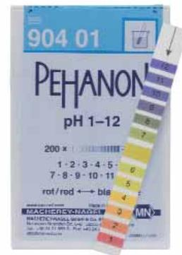
Zur Bestimmung des pH-Wertes in farbigen Lösungen.
