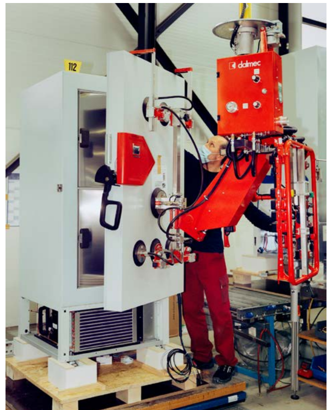
Das Highlight, und hier haben die Journalisten gestaunt, ist die Verheiratung des Ultratiefkühlschranks mit seiner Türe.
