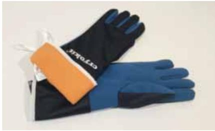
Einsetzbar für alle Arbeiten mit flüssigem Stickstoff und anderen kryogenen Gasen bis ca. minus 196 °C. Schützt vor Kältekontakt und Verbrennungen im Fall des Austretens von tiefkalten Medien. Innere Isolierung: Polyester Mehrschicht-Vlies (410 g/m<sup>2</sup>) und Polyolefin-Porelle-Membrane. Gemäß EN 511, EN 420, EN 388, **Kat.III**. Achtung: Nicht geeignet zum Eintauchen in tiefkalte Flüssigkeiten. Packung à 1 Paar.
