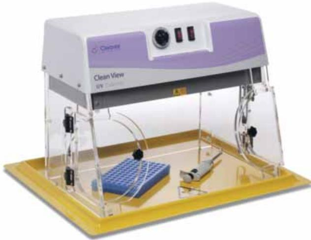
Kostengünstige Alternative zu Reinräumen zur PCR in nukleinsäurefreien Umgebungen. Die vier leistungsstarken UV-Lampen denaturieren Nukleinsäuren sicher in 5 bis 30 min. Schutz des Anwenders vor UV-Licht durch Sicherheitsschalter in den Türen. Timerfunktion für UV-Leuchte. Die aus 10 mm Acryl gefertigte Kammer dient auch als effiziente Abschirmung gegen Beta-Strahlenemissionen und können daher sicher mit Isotopen wie <sup>32</sup>P verwendet werden.
