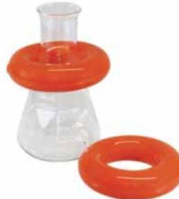
Zur Stabilisierung von Glas- oder Kunststoffgefäßen in Wasser- und Ölbadern. Die Vinyl-beschichtete Oberfläche verhindert das Zerkratzen der Glas-Oberfläche.
