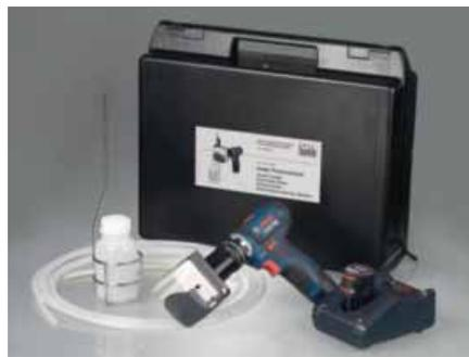
Die selbstansaugende Peristaltikpumpe ist auch für verschmutzte oder partikelhaltige Substanzen mit einer Viskosität von max. 500 mPas geeignet. Ideal zur Probenahme aus Fässern, Tanks, Brunnen, Wasserabscheidern, Abwasser- und Kläranlagen. Die Proben werden über das geschlossene Schlauchsystem direkt in den Probenbehälter geleitet.
