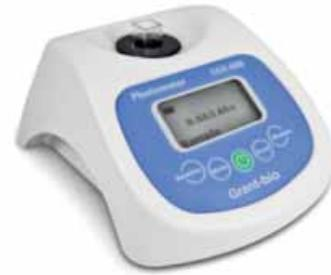
Tragbares Dichtemessgerät für die OD600-Methode, McFarland-Methode (McF) zur Messung der Trübung und die Bradford-Protein-Assay-Methode zur Bestimmung der Proteinkonzentration.
