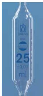
BLAUBRAND®, DE-M gekennzeichnet, AR-Glas®, DIN EN ISO 648. Justiert auf EX. Ringmarke und Beschriftung in kontraststarker blauer Emailfarbe. Inkl. einem USP-Chargenzertifikat. Chargen- und Einzelzertifikate sind auch auf der Webseite des Herstellers zum Download verfügbar.
