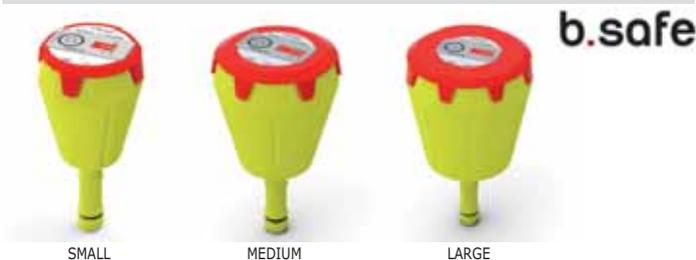
Deckel mit integrierten Belüftungsöffnungen und Wechselanzeige. Die Aktivkohlefüllung wird durch zwei Filtermembranen aus porösem PE geschützt. Gleichzeitig kann die Abluft hindernisfrei die Aktivkohle umströmen, so dass die Bestandteile von Lösemittel zuverlässig von der Aktivkohle aufgenommen und nur gefilterte Abluft in die Umgebung austritt. Verwendbar für alle Abfallkappen mit GL14 Gewinde.
