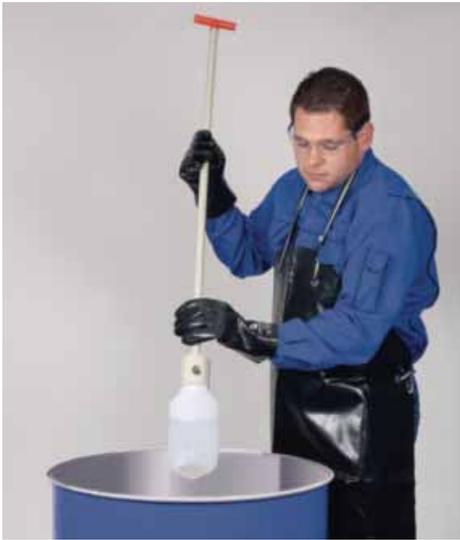
Grau. Für Probenahmen aggressiver Flüssigkeiten, wie Säuren, Laugen, Reiniger. Die Probe fließt direkt in die aufgeschraubte Original-Probenflasche. Der Flaschenverschluss mit Originalitäts-Sicherheitsring gewährt unverfälschten Probentransport.
