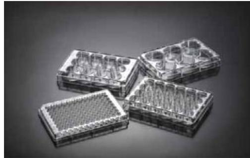
Zellkulturplatten mit behandelter Oberfläche für die Kultivierung von adhären Zellen. Bedingt durch erhöhte Well-Ränder sowie einem Kondensationsring im Deckel ist die Verdunstung reduziert.
