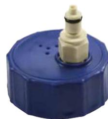
Die Flaschenverschlüsse mit Schnellkupplung oder FitQuik®-Schlauchanschluss integriert in einem Verschluss für alle gängigen Laborflaschen mit Gewinde GL 45, blau. Die BQ45GL Serie verfügt über ein hydrophobes Belüftungsventil, eine Polyethyldichtung und einen integrierten Schlauchstutzen mit 1/4" (6,35 mm) ID zur Montage eines Tauchrohres.
