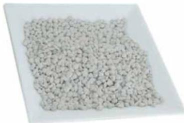
Speziell für analytische Arbeiten. Einsetzbar für Destillationen in saurem, neutralem und basischem Milieu. Für Vakuumdestillation nicht geeignet. Wirksam in kleinsten Flüssigkeitsmengen, auch nach mehrfachen Unterbrechungen. Verhindern jedes Stoßen. Keramisches Produkt mit relativ hoher Reinheit und Abriebfestigkeit.
