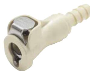
PMC12-Kupplung beige, für anspruchsvollere Anwendungen, wie mikrobiologische Untersuchungsgeräte, Reiniger-Konzentrate, Galvanikflüssigkeiten, Sterilisationsgeräte und Wasserschadstoffanalyse. Beide Kupplungsteile sind mit einem Ventil ausgestattet. Beim Trennen der Kupplung schließen beide Seiten dicht ab. Hauptkomponenten und Absperrventil aus PP. Entriegelungstaste, Federn und Stifte aus Edelstahl 316. Material O-Ringe: EPDM
