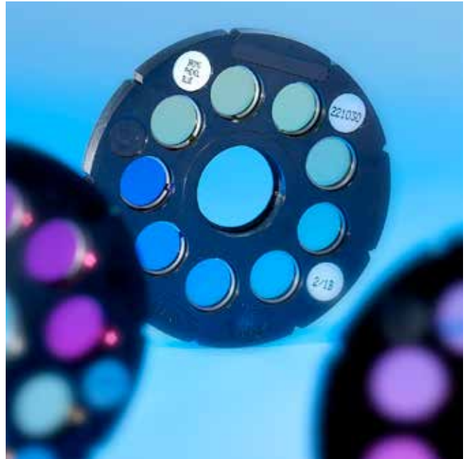
Farbscheiben mit lichtbeständigen Glasfiltern
