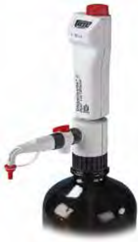
3. Roten Drehknopf herausziehen und den ermittelten Ist-Wert (hier 9,90 ml) einstellen.
