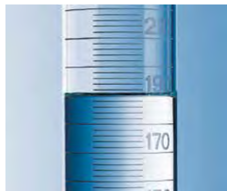
SILBERBRAND. Strichteilung. Ablesung erfolgt am tiefsten Punkt des Meniskus.
