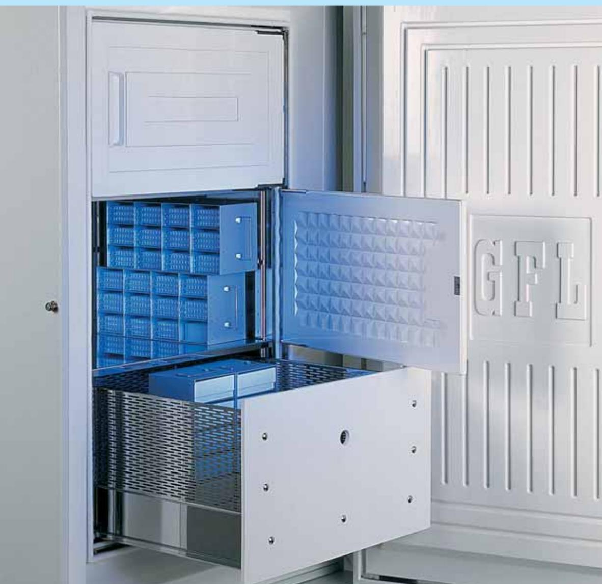
**6485** Tiefkühlschrank, 500 Liter, Sonderausstattung mit zwei Standardfächern und großer Schublade aus Edelstahl-Rostfrei mit gelochter Seitenerhöhung und 10 mm dicker Isolier-Kunststoffabdeckung mit Griffloch. Lagersystem für Testplatten und Boxen.
