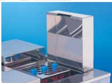
Doppelwandige, innen gewölbte Deckel wirken wärmeisolierend und verhindern das Zurücktropfen von Kondensat in die Gefäße
