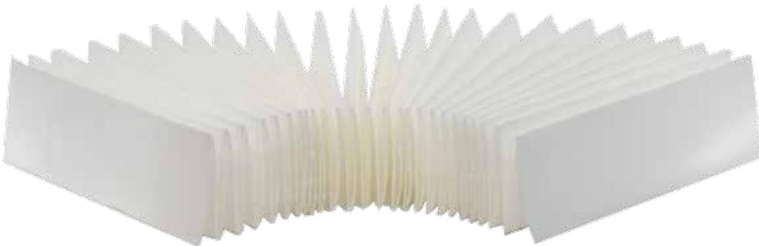
Papiere in plissierter Form mit genau 50 Doppelfalten ermöglichen einen besseren Kontakt der Samen mit dem Nährmedium und gewährleisten eine bessere Trennung der einzelnen Samen.
