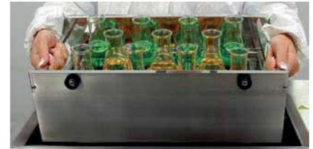
Mit dem herausnehmbaren Schüttelwagen vermeiden Sie direkten Kontakt mit der Badflüssigkeit und Sie können die Tablare bequem außerhalb des Bades bestücken.
