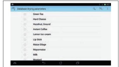
Waageninterner Speicher für den automatischen Ablauf von 300 Trocknungsprogrammen (pro Speicherplatz 12 freie Zeichen). Viele nützliche Programme bereits vorinstalliert
