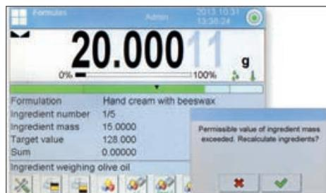
**Komfortables Rezeptieren:** komplette Rezepturen mit allen Rezepturbestandteilen und den dazugehörigen Sollwerten, Namen, Toleranzen, Taragewichten etc. können hinterlegt werden. Die praktische Rezepturanpassung bei Überdosierung ermittelt bei einem Rezepturbestandteil mit einer zu hohen Einwaage automatisch die neuen Sollgewichte der anderen Rezepturbestandteile
