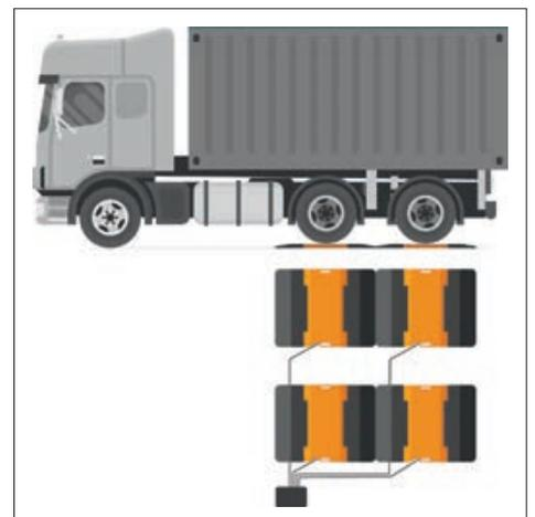
**Gleichzeitiges Verwiegen von Doppelachsen, z. B. eines Aufliegers**
