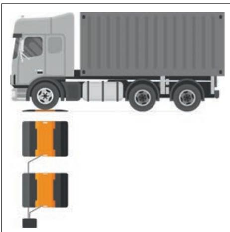
**Asynchrones Verwiegen einzelner Achsen**
