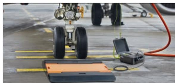
**Verwiegen von Flugzeugen** zur Berechnung des Ladeplans und der Bestimmung des Schwerpunktes, um sicherzustellen, dass das zulässige Gesamtgewicht nicht überschritten wird und das Gewicht korrekt verteilt ist
