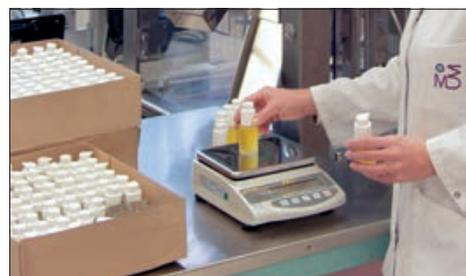
**Wägen mit Toleranzbereich (Checkweighing):**
