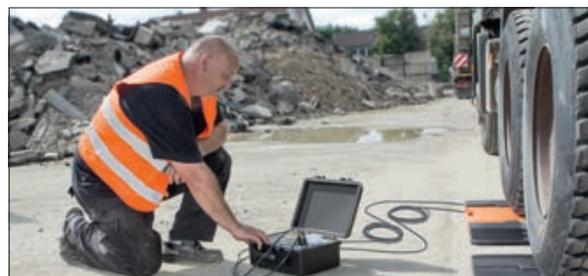
**Verwiegen von Zugmaschinen, Anhängern, Lastkraftwagen etc.** zur Kontrolle im Bereich der Anlieferung und Auslieferung von Waren & Gütern an Orten, an denen keine fest eingebaute Fahrzeugwaage zur Verfügung steht oder aus Kostengründen nicht vorhanden ist
