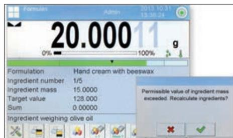
**Komfortables Rezeptieren:** komplette Rezepturen mit allen Rezepturbestandteilen und den dazugehörigen Sollwerten, Namen, Toleranzen, Taragewichten etc. können hinterlegt werden. Die praktische Rezepturanpassung bei Überdosierung ermittelt bei einem Rezepturbestandteil mit einer zu hohen Einwaage automatisch die neuen Sollgewichte der anderen Rezepturbestandteile
