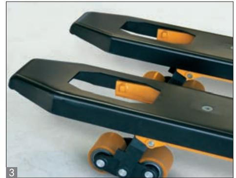
Wiegehubwagen mit komplettem Staub- und Spritzwasserschutz IP65/67 und Speicherplatz für ein Behältergewicht
