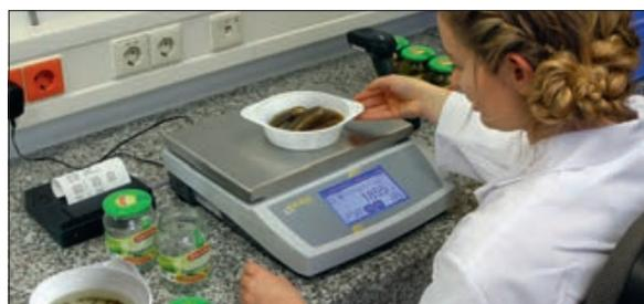
Probenprüfung einer Fertigpackung mit entleertem Inhalt (probenzerstörende Auswertung)
