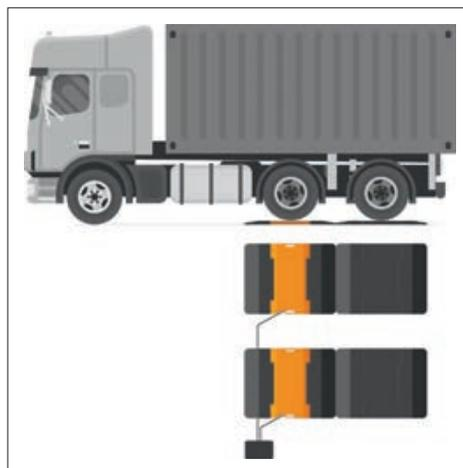
**Asynchrones Verwiegen von engstehenden Doppelachsen, mit unterstützenden Ausgleich-Pads**
