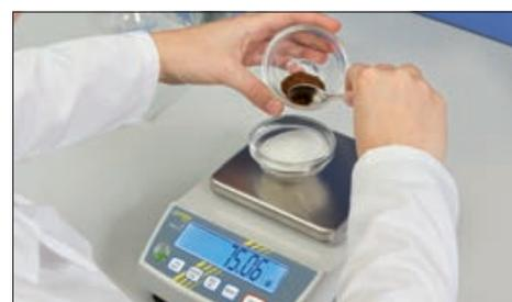
Mit der **Rezepturfunktion** lassen sich verschiedene Bestandteile einer Mischung zuwiegen. Zur Kontrolle kann das Gesamtgewicht aller Bestandteile aufgerufen werden
