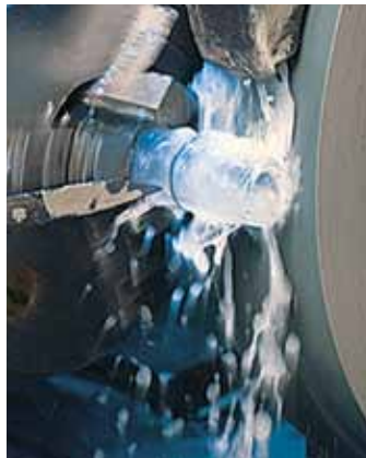
NS-Kerne werden auf halbautomatischen Rundschleifmaschinen weiterbearbeitet.
