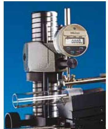
Konizitätsprüfung: Mittels hochgenauer Kegelmessgeräte wird die Präzision unserer Schliffe überwacht.
