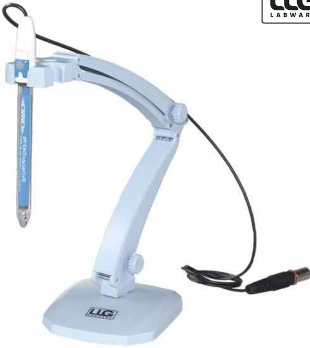
Mit Kabelführung. Für 3 Elektroden, 3 Öffnungen mit Ø 16 mm. Eine weitere Öffnung für Temperaturfühler. Durch 3 Gelenke sehr flexibel einstellbar.
