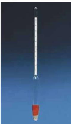
Mit Schrotbelastung. Ohne Thermometer. Bezugstemperatur +20 °C.
