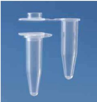
Farblose 0,2 ml und 0,5 ml PCR-Gefäße mit anhängendem Deckel sind für den Einsatz in Thermocyclern mit beheizbarem Deckel aller gängigen Hersteller geeignet.
