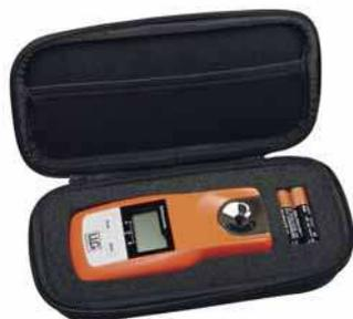
LLG-uniREFRACTO 5 pro ist ein kompaktes digitales 3-Skalen Handrefraktometer zur Messung von u.a. des Zuckergehaltes und des Brechungsindex von Flüssigkeiten. Zwei Skalen sind auf 0 - 95 % Brix und 1,33 - 1,54 RI voreingestellt, die dritte Skala kann frei aus mehr als 45 verschiedenen Skalen ausgewählt werden, einschließlich Brix, Brechungsindex, AdBlue®, °Baume, °Butyro, Ethylenglycol %, Calciumchlorid % und spezifisches Gewicht. Alle drei Skalen können frei gewählt und geändert werden.
