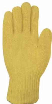
Diese Grobstrickhandschuhe aus 100 % Kevlar® sind zusätzlich an der Innenseite mit einem Baumwollfutter versehen. Das Baumwollfutter auf der Innenseite verhindert ein starkes Schwitzen. Die Kombination KEVLAR® und Baumwolle ergibt eine hohe Hitzeisolation und ermöglicht ein Hantieren von bis zu +250 °C heißen Teilen, ohne auf einen Schnittschutz verzichten zu müssen. Packung à 1 Paar.
