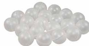
Durchmesser 20 mm. Für eine Fläche von 0,1 m<sup>2</sup>. Verringern das Verdunsten, raschen Temperaturverlust und übelriechende oder korrodierende Dämpfe. Beständig gegen die meisten Säuren, Laugen, Lösungsmittel und Mineralöle. Temperaturbeständig bis 100 °C.
