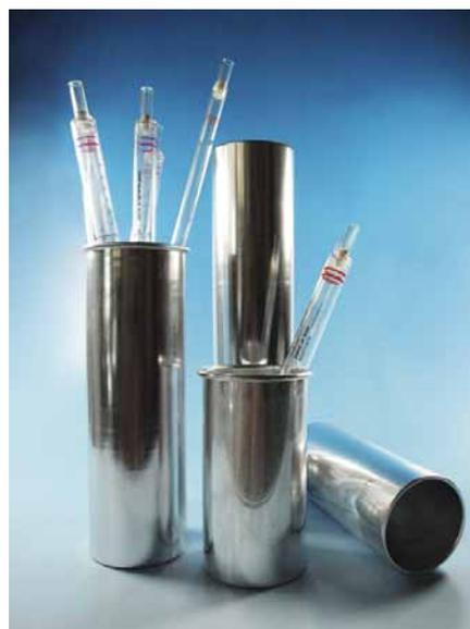
Besteht aus zwei variabel ineinander zu schiebenden Aluminiumteilen, die soweit überlappen, dass Pipetten unterschiedlicher Länge/Volumina sterilisiert und aufbewahrt werden können.
