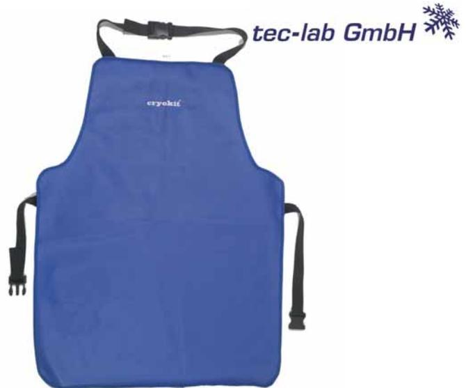
Wasserdicht. Geeignet für alle Laboranwendungen mit Flüssigstickstoff oder anderen kryogenen Gasen. Hergestellt aus einem besonderen extra beständigen und beschichteten Verbundgewebe. Getestet durch 1 Minute in Flüssigstickstoff (-195,82 °C) und anschließendem Flexibilitätstest (RCT-Methode). Mit einstellbaren Clip-Verschläüssen. Mit CE-Zertifikat, gemäß EN 511, EN 388, **CAT. III**
