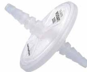
Zur sterilen Be- und Entlüftung von Fermentern, Kulturgefäßen etc. Als Wasserschutz zwischen Saugflasche und Vakuumpumpe. Durch PTFE-Membran und PP-Gehäuse ausgezeichnete chemische Beständigkeit.
