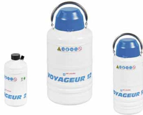
Die Behälter der Serie VOYAGEUR sind speziell für den Transport von biologischen Proben bestimmt. Der Flüssig-Stickstoff wird im Behälter von einer porösen Masse aufgesaugt, so dass die Lagerung der Proben in der Gasphase erfolgt und selbst bei einem möglichen Unfall kein Flüssig-Stickstoff auslaufen oder herausspritzen kann.
