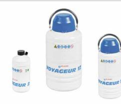
Die Behälter der Serie VOYAGEUR sind speziell für den Transport von biologischen Proben bestimmt. Der Flüssig-Stickstoff wird im Behälter von einer porösen Masse aufgesaugt, so dass die Lagerung der Proben in der Gasphase erfolgt und selbst bei einem möglichen Unfall kein Flüssig-Stickstoff auslaufen oder herausspritzen
