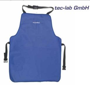
Wasserdicht. Geeignet für alle Laboranwendungen mit Flüssigstickstoff oder anderen kryogenen Gasen. Hergestellt aus einem besonderen extra beständigen und beschichteten Verbundgewebe. Getestet durch 1 Minute in Flüssigstickstoff (-195,82 °C) und anschließendem Flexibilitätstest (RCT-Methode). Mit einstellbaren Clip-Verschlüssen. Mit CE-Zertifikat, gemäß EN 511, EN 388,
