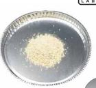
Hochwertiges Reinstaluminium, auch zur Feuchtebestimmung sehr gut geeignet.
